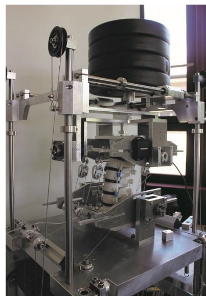
3D gedrucktes Lendenwirbelsäulen-Modell, eingebaut im Simulator mit einer Vorlast von 20 kg.
