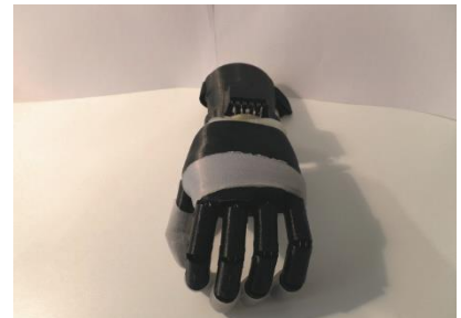
3D-gedruckte, adaptive Handprothese mit rein mechanischer Ansteuerung
