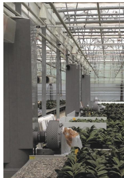
Versuchsstand im Gewächshaus. Füllkörperwäscher beliefern konditionierte Luft an die Pflanztische.
