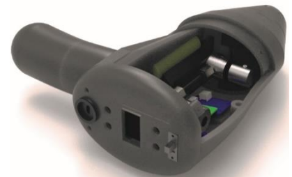
Entwickelter Prototyp. Mit diesem Handheld-Gerät ist es möglich, eine thermografische Untersuchung durchzuführen.
