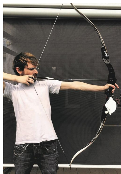
Der Prototyp im Einsatz. Unterhalb des Bogengriffes ist das Gerät in einem weissen 3D-gedruckten Gehäuse. Vier FSR-Sensoren erfassen die Kräfte auf dem Griff.
