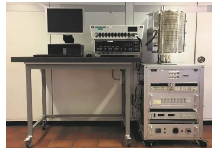
Teststand für das Durchführen von Messungen an SOFC-Brennstoffzellen am IMPE.
