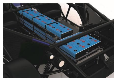
Zellanordnung in einem eRod
