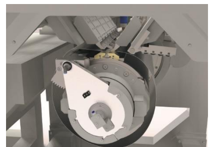
Detailansicht der Mechanik zum Umformen und Positionieren des Blechtes innerhalb der Anlage
