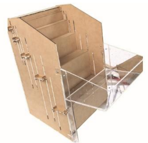
Funktionsmuster eines handbetriebenen Stufenförderers zur Vereinzelung aus MDF-Platten
