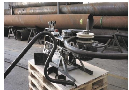
Profilbiegemaschine mit gewalzten sowie gebogenen Stahlprofilen
