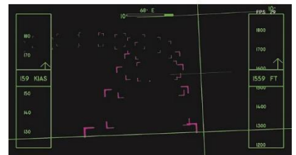
Highway-In-The-Sky: Der Pilot wird zur Landung geführt.
