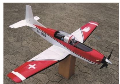
Skaliertes und dynamisch angepasstes Modell der Pilatus PC-7 mit eingebauten Sensoren: Die gewichtsbedingt hohe Fluggeschwindigkeit erfordert einen geübten Piloten und ein weiträumiges Fluggelände.
