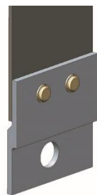
Asymmetrischer Prüfkörper aus Carbon, vernietet mit einem Adapter zur Lasteinleitung
