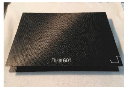
In der Arbeit selbst hergestellte Spar-Skin-Box für die Versuchsreihe.
