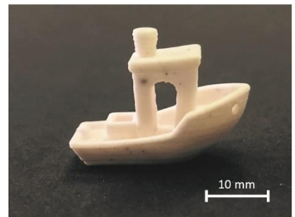
3D-gedruckte Testgeometrie "3DBenchy" für die Kalibration der Druckparameter. Das Drucken komplexer Strukturen konnte realisiert werden. Mit wenig Nachbehandlung konnte auch die Oberflächenstruktur geglättet werden.
