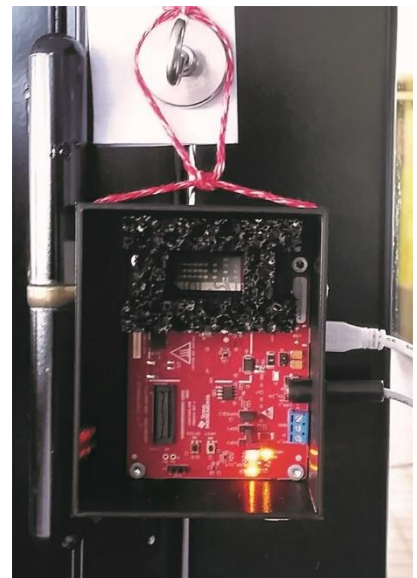
AWR1443 Evaluation Module mit Abschirmungsmaterial
