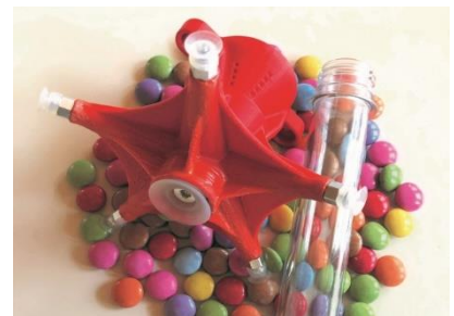
Robotergreifer für Smarties und PET-Rohling
