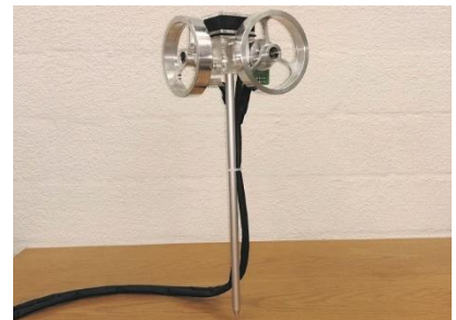
Der Stab wird durch die Gleichgewichtsregelung mit den Reaktionsrädern balanciert.
