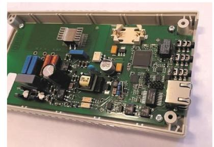
Ein Blick auf die vom Industriepartner entwickelte Hardware eines Webnodes. Als Prozessor kommt ein ARM Cortex-M3 mit 72 MHz, 64 kB SRAM und 256 kB Flash-Speicher zum Einsatz.
