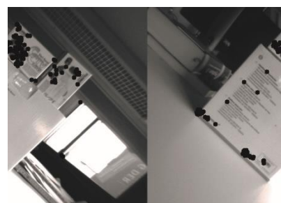
Detektierte Punktwolke, anhand welcher die Bewegung ermittelt wird
