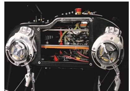
Durch die Entwicklung eines Elektronik-Stacks, bei welchem die Elektronik-Komponenten auf drei Ebenen angeordnet sind, können sämtliche Komponenten kompakt und wartungsfreundlich eingebaut werden.
