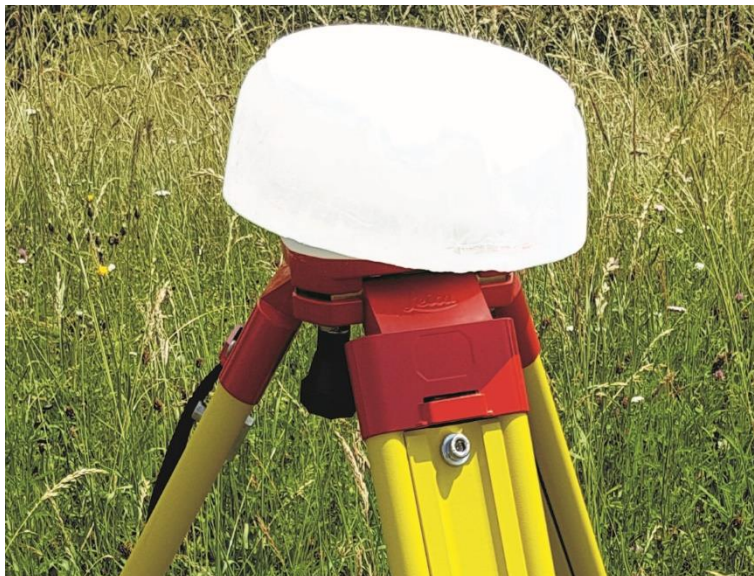
Messung vom 31.05.2018 mit 6 cm dickem Eis über der Antenne.
