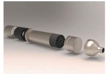
Render von einem Raketenantrieb, welches mithilfe der Software entwickelt wurde. Das 3D-Modell wird anschliessend benutzt, um die Software zu validieren.
