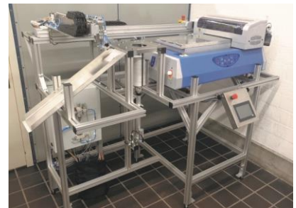
Bestückungsroboter für Bourdon- Ziffernblätter
