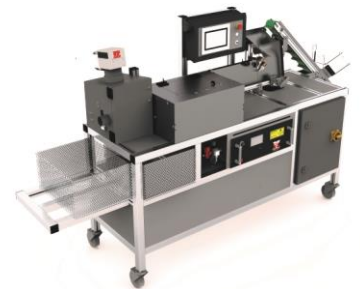
Realisierte Lösung der Maschine "Qualitätskontrolle von Bourdon- Tubes"
