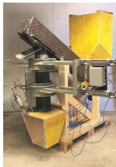
Das Bild zeigt den Prototyp der automatisierten Holzschnitzelzuführung. Mit der Förderschnecke werden die Holzschnitzel in das Schleusensystem transportiert. Der Füllstandsensoren erkennt die Schnitzelmengen im Reaktor.
