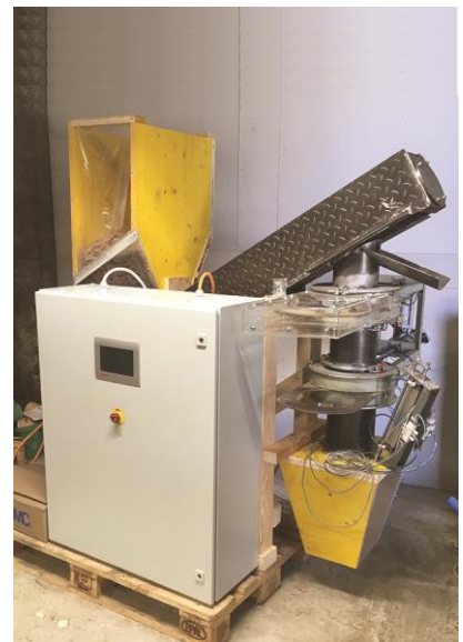
Dieses Bild zeigt den kompletten Aufbau der automatisierten Holzschnitzelzuführung. Links ist der Bunker, mittig die Förderschnecke und rechts das Schleusensystem mit dem Reaktor abgebildet. Im Vordergrund ist der Schaltschrank mit dem eingebauten Panel-PC zu sehen, mit welchem der Prozess gesteuert und visualisiert wurde.
