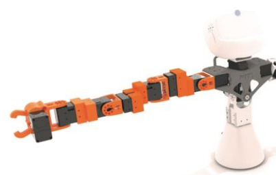
Neu entwickelter Greifarm für den humanoiden Roboter Poppy.
