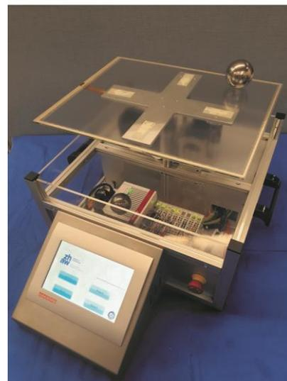
Ball on Plate-Demonstrator mit
