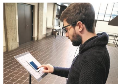
Testaufbau zur Erstellung unseres Validierungs-Datensatzes mit gleichzeitiger Aufnahme des Blickes der Testperson über die Smartphone-Kamera und die Eye-Tracking-Brille.
