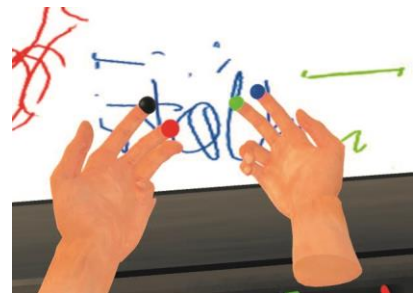
Verwendung von Datenhandschuhen an einem Whiteboard in VR. Mehrere Farben pro Hand ermöglichen effizientes und intuitives Zeichnen und Schreiben.
