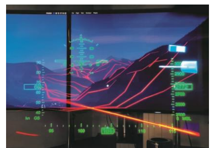
Blick durch die HoloLens: X-Plane-Gelände mit überlagertem Geländegitter und Fluginstrumenten.
