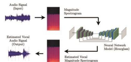
Aus dem Audiosignal eines Musikstücks werden Spektrogramme erzeugt. Das vorher trainierte Netzwerk nimmt diese Daten als Input und berechnet daraus eine Schätzung für das Spektrogramm der Gesangsspur, welche in ein Audiosignal zurückverwandelt wird.
