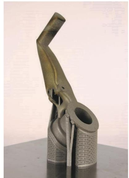
Radschwinge mit ANSYS Additive Suite und ANSYS Additive Print simuliert, per SLM gefertigt, mit 3D-Laserscanner vermessen und die Deformationen im Vergleich zu den Simulationen ausgewertet.
