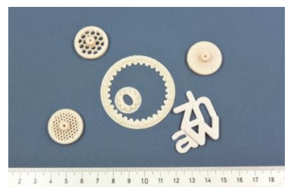
Fotos der Modellteile mit Massstab in Zentimeter. Verschiedene Modellteile wurden mit Aluminiumoxid (P172LSB) getestet.
