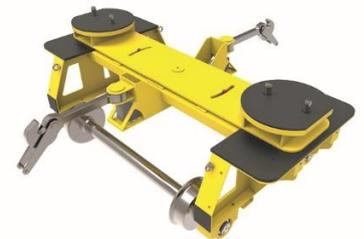
Das entwickelte Hilfsdrehgestell (HDG) ist als Blech- und Schweisskonstruktion ausgelegt.
