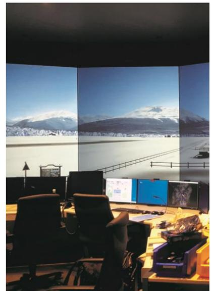
Ein Tower-Simulationsraum bei Skyguide mit einem 360 Grad-Bildschirm. Dieser erlaubt, Air Traffic Control Operators unter realistischen Bedingungen zu trainieren.
