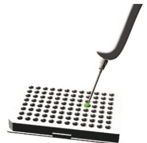
Instruieren eines Flüssigkeitstransfers in der Augmented Reality-Applikation, durch Selektieren von Nöpfchen einer Mikrotiterplatte mit der virtuellen Pipette
