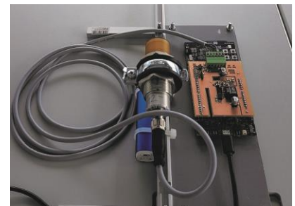
Baumer RS485-Radarsensor mit dem nRF52840 Development Kit von Nordic Semiconductor und dem darauf aufgesteckten Print für die Netzwerkintegration des Sensors.
