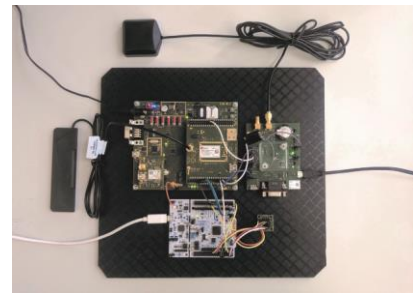
Aufbau GPS-Tracker mit Evaluations-Kits
