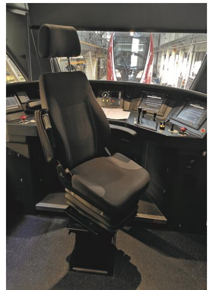
Eingebauter Lokführersitz MSG 90.3 von Grammer in S-Bahn-Triebzug
