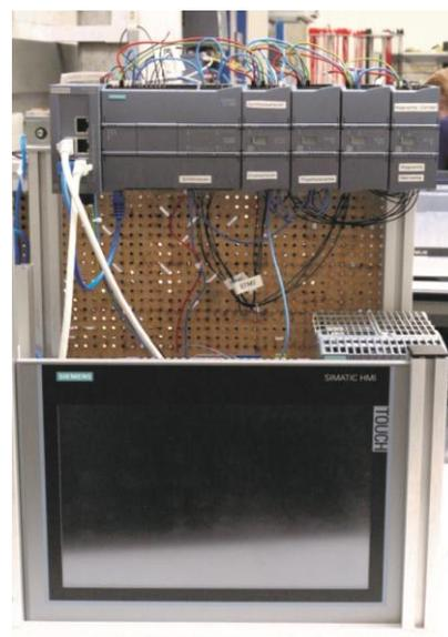
Prototyp des Prüfstands. Im Bild ist die Steuerungseinheit zusammen mit dem Touchpanel zu sehen.
