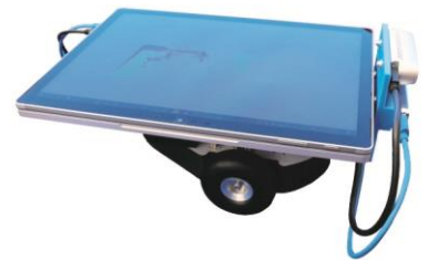
Robotersystem mit Tracking- und Tiefen-Kamera
