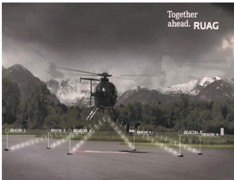
Der Test-Helikopter der RUAG im Anflug auf den Landeplatz Alpnach CH mit der Hilfe des Systems DeckFinder. Systemtesting RUAG und Airbus 2012
