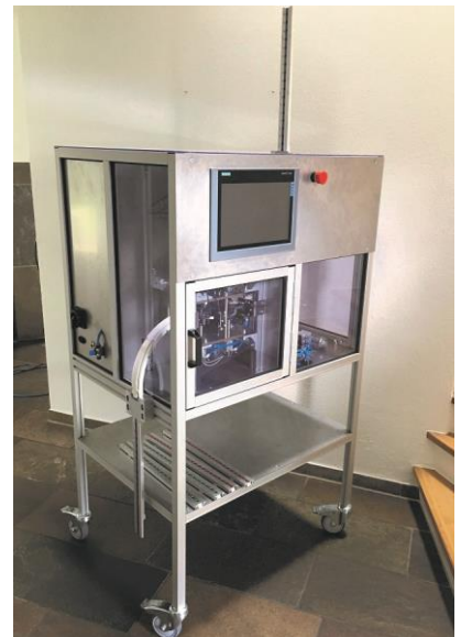
Zusammengebauter Prüfstand für Einwegventile
