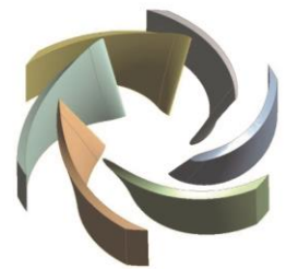
3D Referenzgeometrie der zu optimierenden Pumpe
