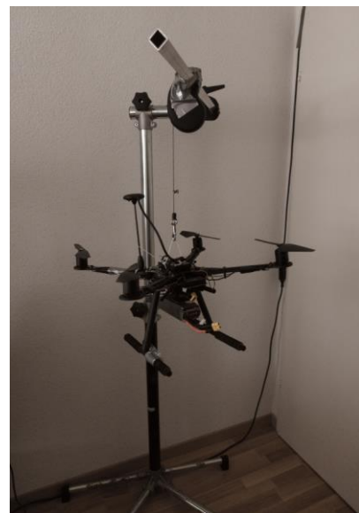
Drohnenestanlage (Quelle: Eigenes Bild)
