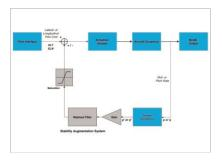
Das obere Schema zeigt eine vereinfachte Implementation des im Laufe der Arbeit entwickelten Stability and Control Augmentation Systems (SCAS) für das XV-15 Modell
