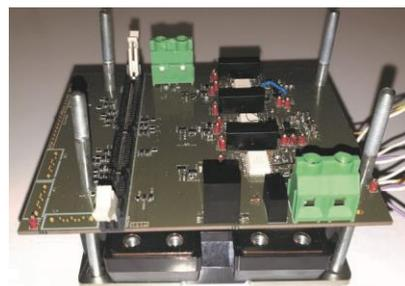
Entwickelte Hardware über dem Leistungsmodul
