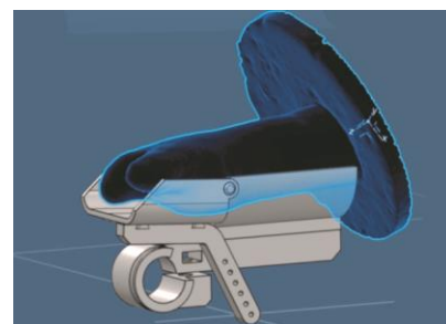
Ein CAD-Modell des entwickelten Hilfsmittels mit einem gescanntem Modell der Hand des Knaben
